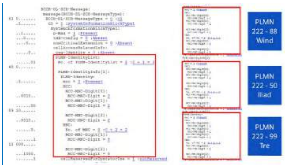
Figura 10 - Decodifica del messaggio contenuto nei simboli relativi alle SIB1 del segnale LTE
