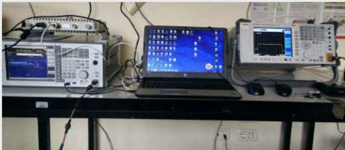
Figura 11 - Setting strumentale per la acquisizione e rigenerazione I/Q laboratorio Arpa Lazio di Roma
