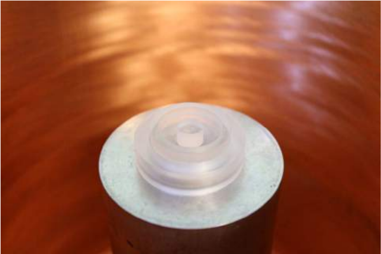
Figura 2 – Contenitore plastico per le misure mensili di fallout posizionato su un rivelatore HPGe: il residuo secco (4 g) è distribuito uniformemente in una sottile geometria cilindrica altamente riproducibile, anche grazie a un tappo che comprime il materiale.
