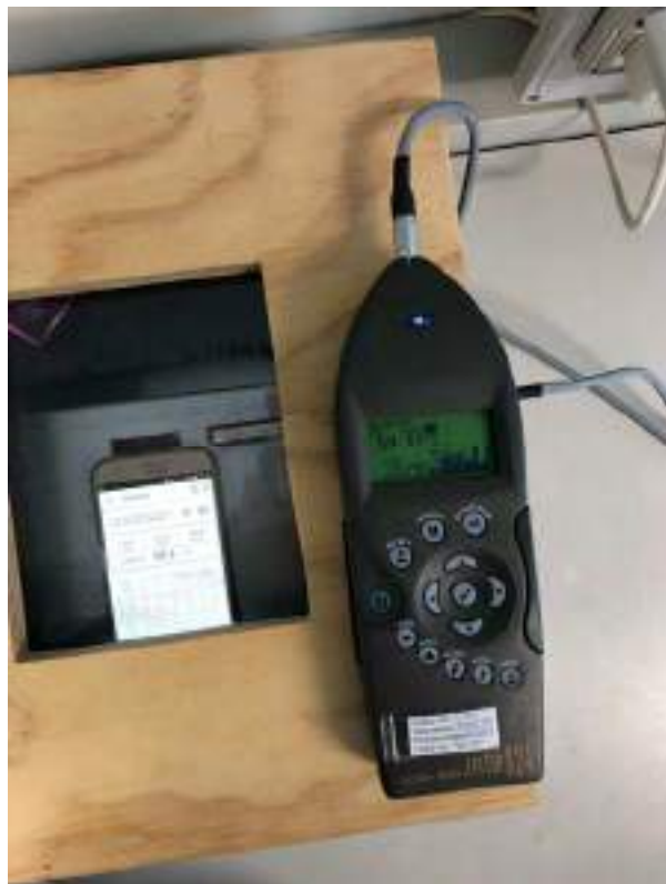
Figura 2 – calibrazione di uno smartphone per confronto con un fonometro
