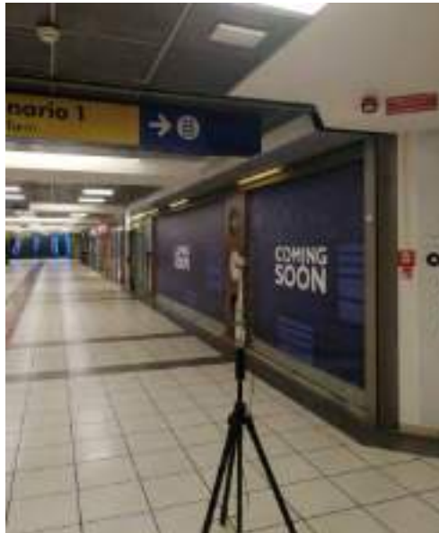
Figura 5 - Misura in banda larga in corrispondenza di un hot spot
