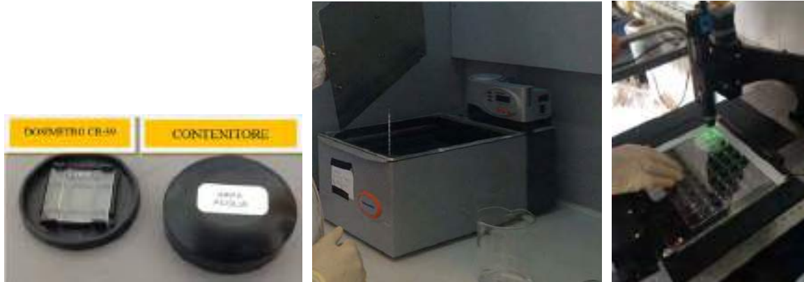
Figura 2 – Immagine dei rivelatori CR-39, bagno termico per lo sviluppo chimico e sistema ottico Politrack.
