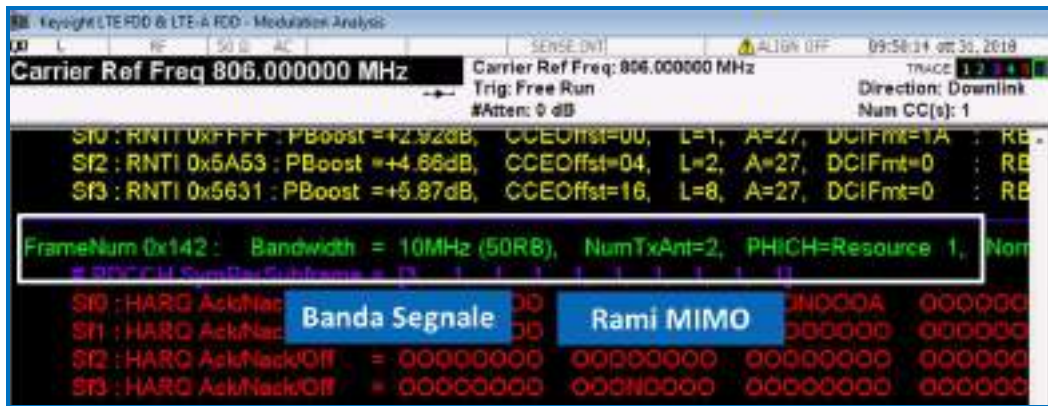
Figura 3 - MIB decodificato sul canale PBCH con analizzatore Keysight mod. MXA9020A
