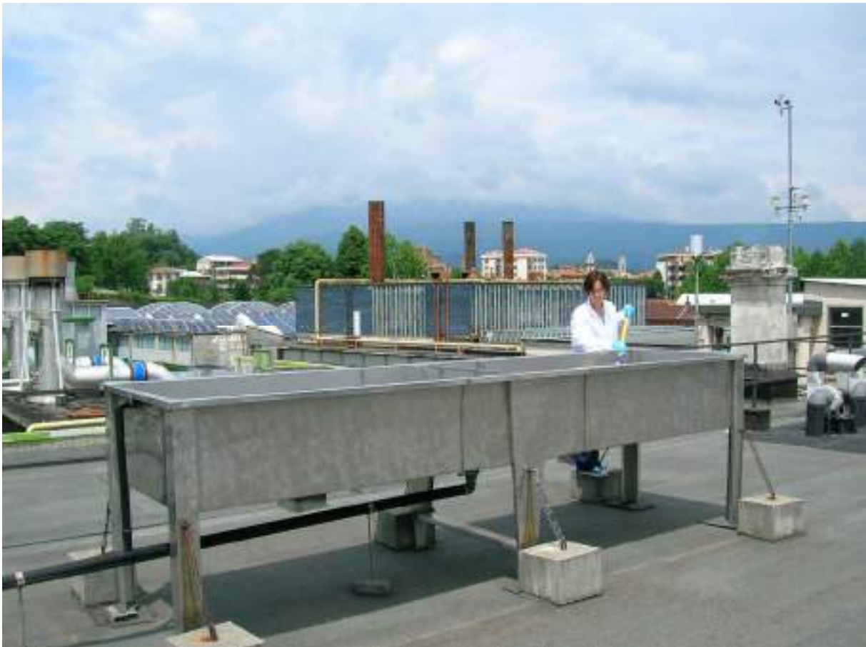
Figura 1 – Vasca in acciaio inox, con superficie di raccolta del fallout di 4 m 2 , posta sul tetto (III piano) dell’edificio in cui ha sede il laboratorio Arpa Piemonte di Ivrea. Lo svuotamento avviene mensilmente tramite un tubo che convoglia l’acqua raccolta direttamente nel laboratorio.
