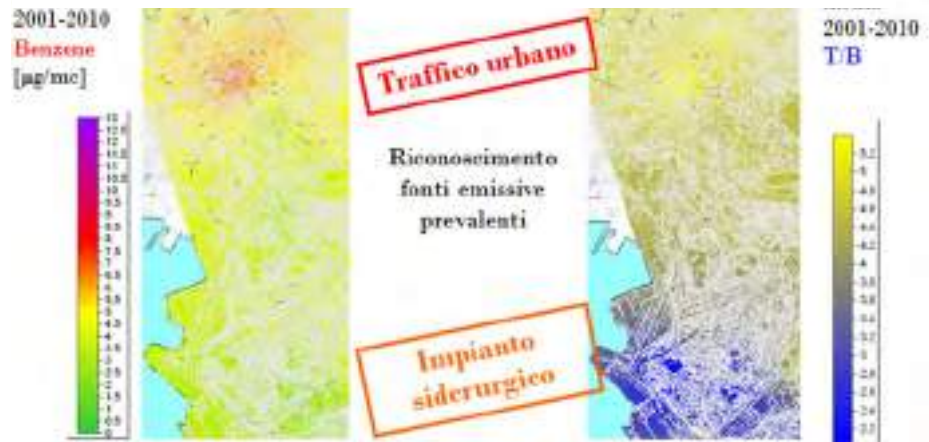
Figura 5 – Interpolazione spaziale del benzene (a sin.) e del rapporto Toluene/Benzene (a dx.)
