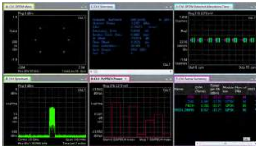
Figura 6 - Schermata di analisi del segnale 5G del software VSA
