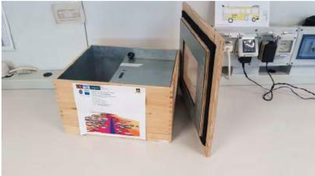
Figura 1 – camera riverberante per la calibrazione degli smartphone
